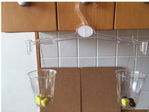
OBRÁZEK 3.5 | Výroba rovnoramenných vah pomocí misek a šatního ramínka 5
